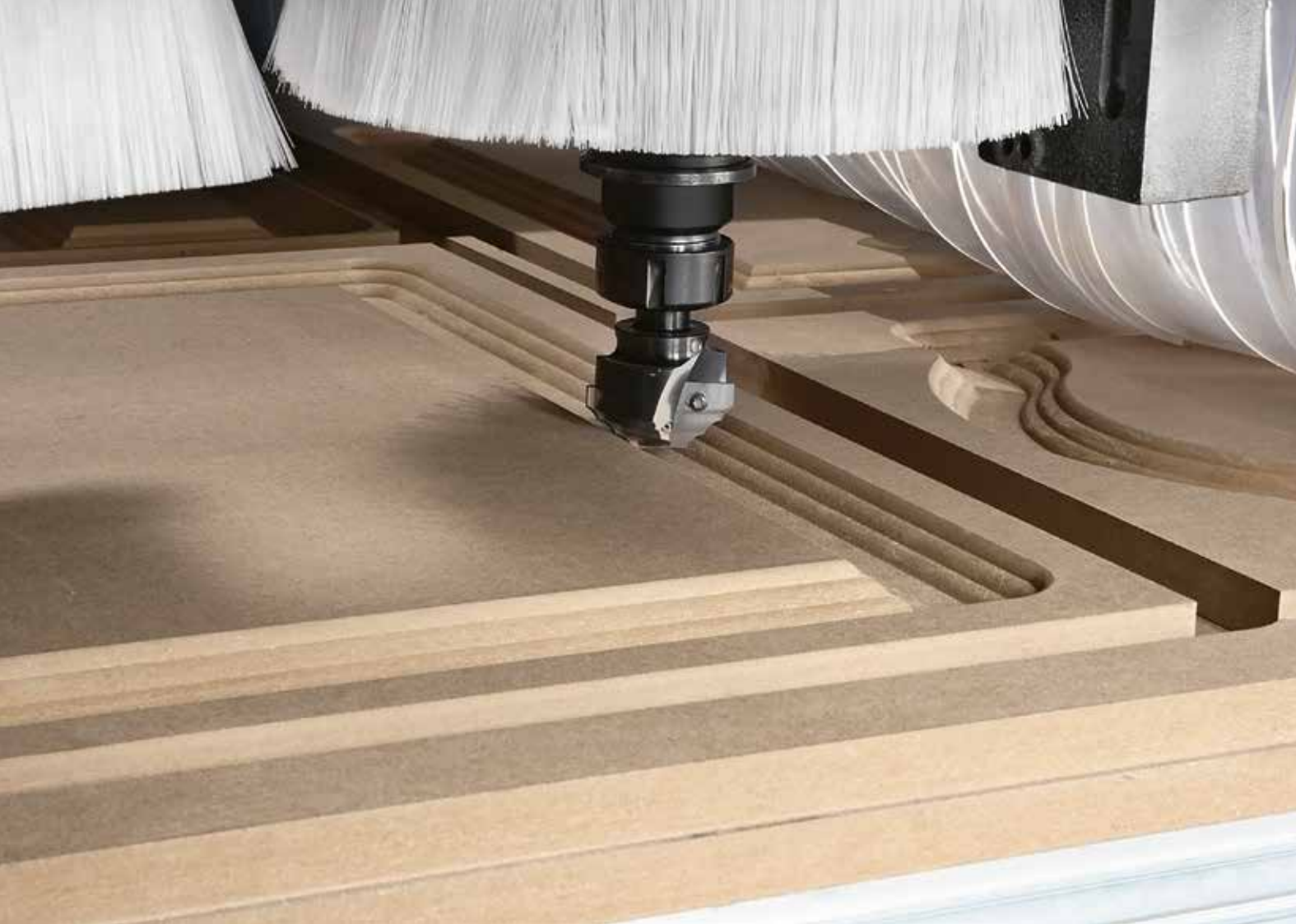
Ottima precisione di lavorazione con l'elettromandrino a 3 assi fino a 24000 g/min.
